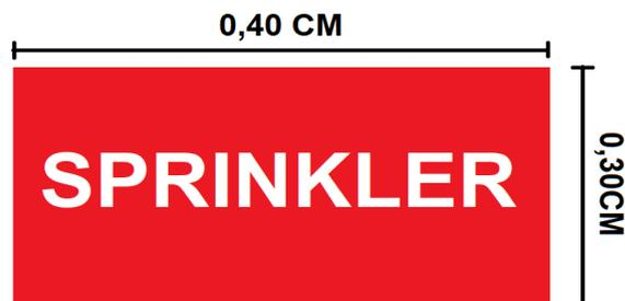
Figura 4 - Sinalização do registro de recalque do sistema de chuveiros automáticos em parede ou no muro.
