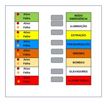
Em caso de emergência, deve ser possibilitado ao operador sobrepor as automações previstas no SDAI com comandos manuais específicos, por exemplo, ativar manualmente o sistema de extração de fumaça mesmo que um detector não tenha sido acionado.
