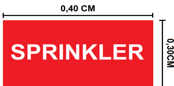
Figura 4 - Sinalização do registro de recalque do sistema de chuveiros automáticos em parede ou no muro.
