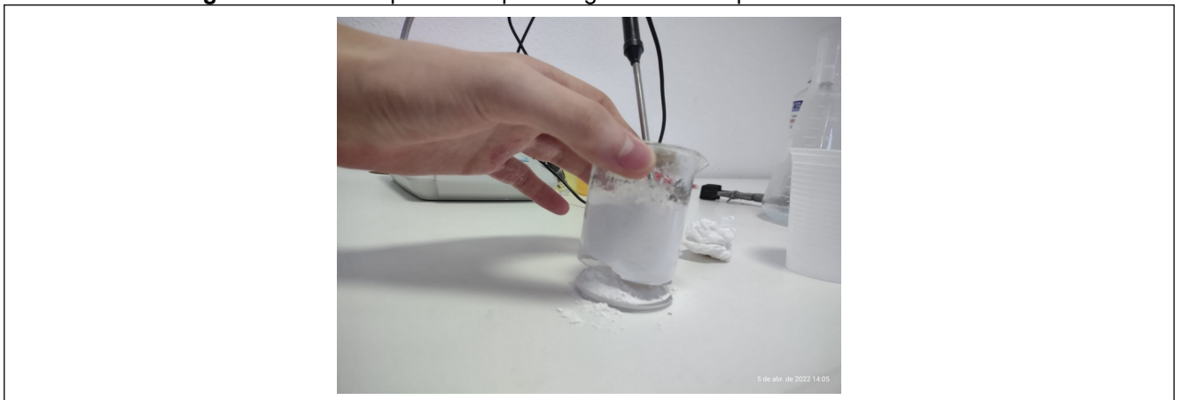
Figura 2 - Vidraria quebrada após chegar a uma temperatura acima de 90 °C.
