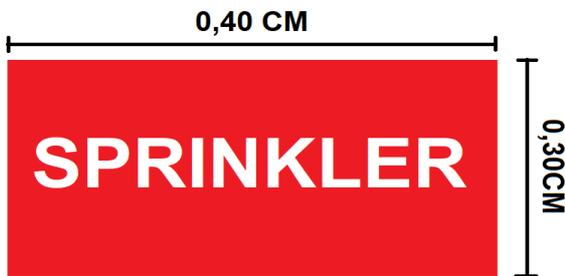
Figura 2 - Sinalização do registro de recalque do sistema de chuveiros automáticos em parede ou no muro.
