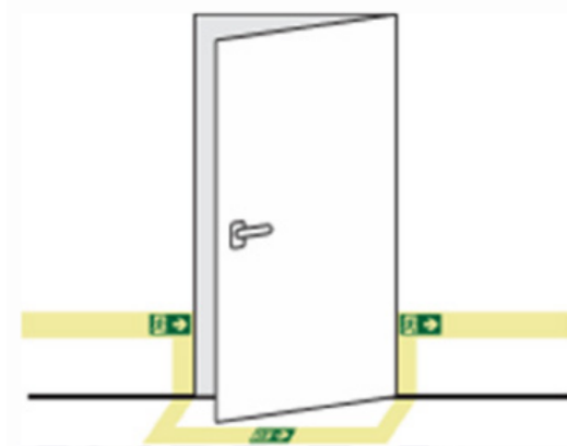
Figura 5 - Sinalização de rota continuada em portas de acesso
