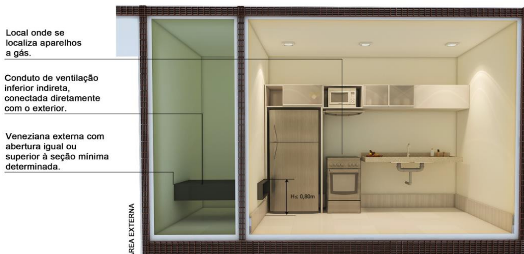
Figura 10 – Abertura inferior permanente para ventilação indireta
