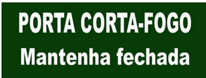
Figura 3 – Sinalização para fechamento de porta corta-fogo conforme NBR 13434.
