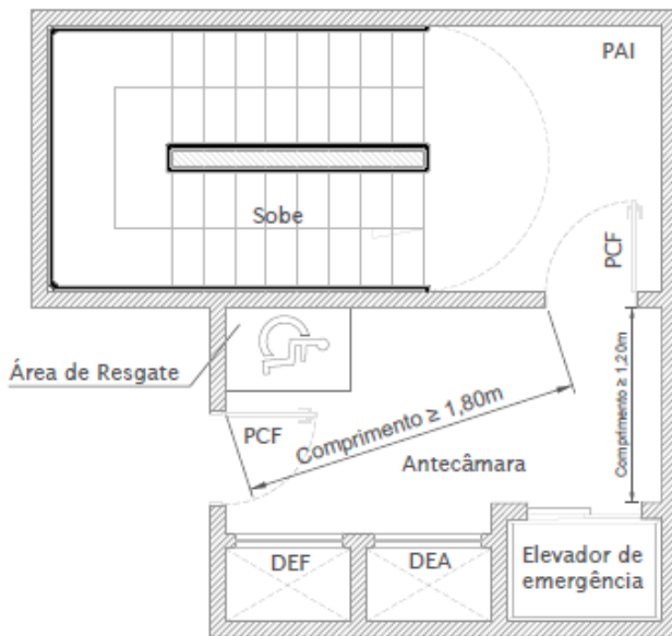
Figura 22 – Elevador de emergência.
