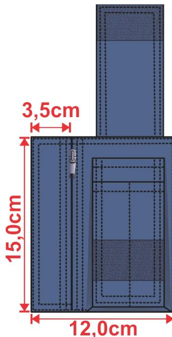
2.16 Frente: Abertura com fechamento através de zíper com dois cursores (um que abre de cima para baixo e outro que abre de baixo para cima) fixado com pesponto duplo.
