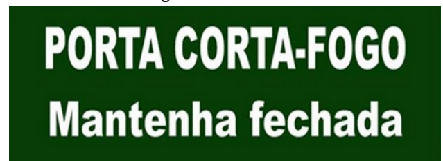
Figura 3 – Sinalização para fechamento de porta corta-fogo conforme NBR 13434.
