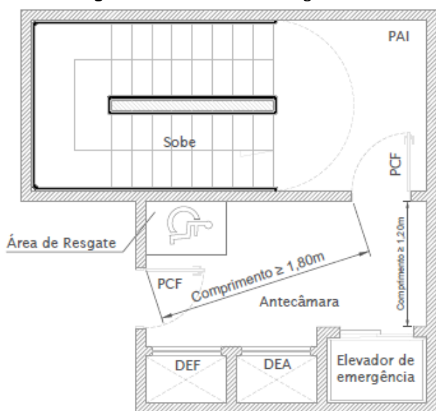
Figura 21 – Elevador de emergência.
