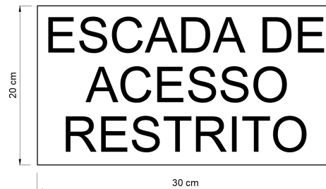
Figura 11 – Placa indicativa de escada para local de acesso restrito.
