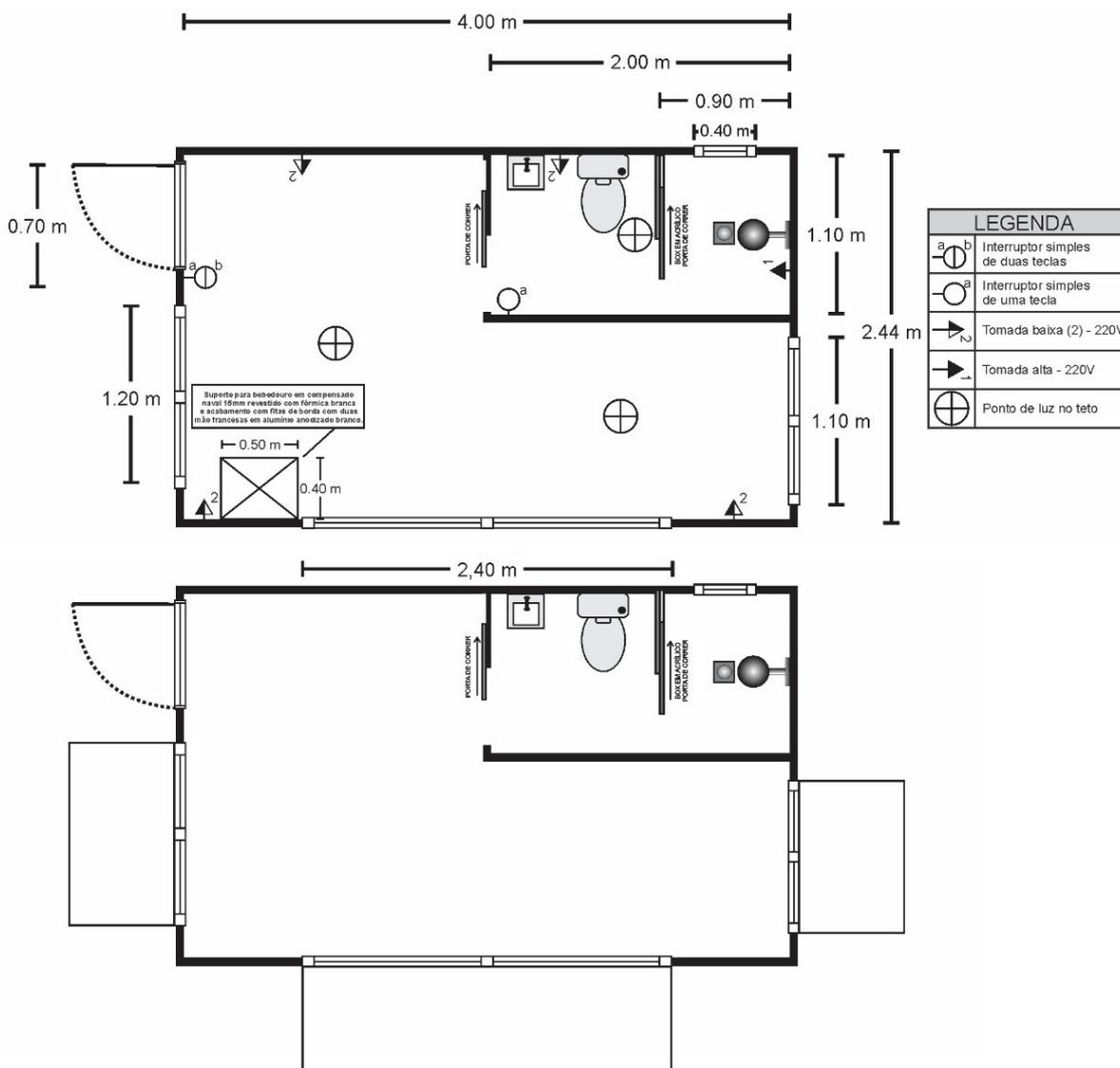
2.1.7 A instalação sanitária interna do container deve ser executada de forma completa, deixando-se uma espera a fim de ser posteriormente ligada à fossa lacrada com capacidade de no mínimo 1.800 litros, a qual deverá ser fornecida pela contratada;
